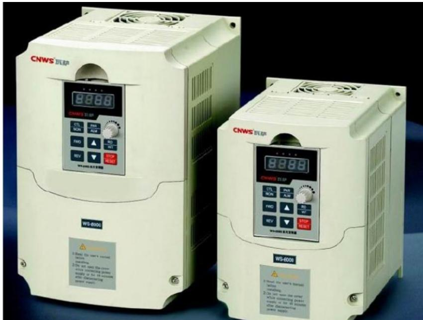
低压变频器的接线：主回路接线。（1）变频器三相交流输入端子[R][S,T][U]电源输入端子通过线路保护用断路器的断路器连接到三相交流电源，无需考虑连接相序。这里要特别注意的是，三相交流电源一定不能直接接到变频器输出端子，否则将导致变频器内部器件损坏。（2）变频器三相交流输出端子[U,V,W]输出端子应按正确的相序接入电机，如果电机方向不对，则交换[U,V,W]中的任意两相即可，也可以通过设置变频器参数来实现。要注意的是，输出端不能接进相电容器和电涌吸收器。随着工业自动化程度的不断提高，变频器得到了非常普遍的应用。杭州高性能变频器供货企业
