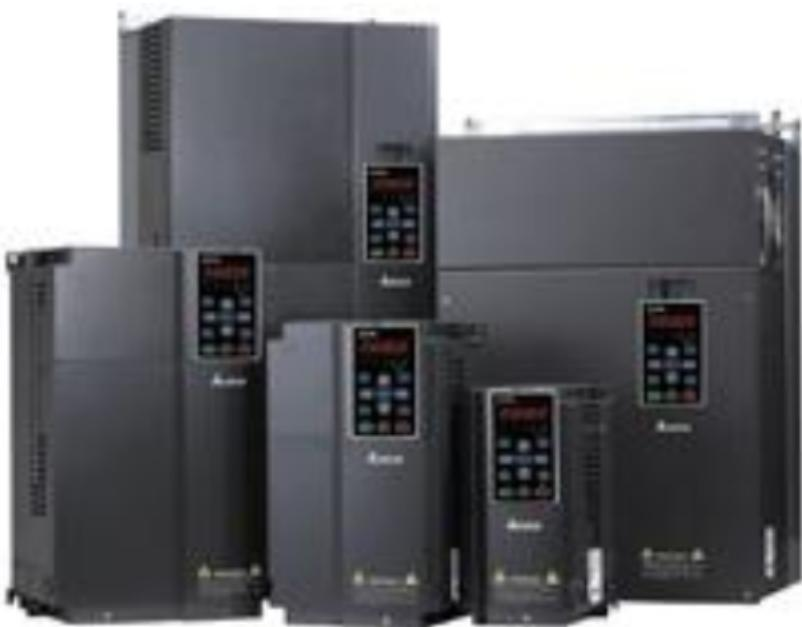
变频器由多种部件组成，其中一些部件经长期工作后其性能会逐渐降低、老化，这也是变频器发生故障的主要原因，为了保证设备长期的正常运转，下列器件应定期更换：冷却风扇。变频器的功率模块是发热很严重的器件，其连续工作所产生的热量必须要及时排出，一般风扇的寿命大约为10Kh—40Kh，按变频器连续运行折算为2—3年就要更换一次风扇，直接冷却风扇有二线和三线之分，二线风扇其中1线为正极，另1线为负极，更换时不要接错。三线风扇除了正、负极外还有一根检测线，更换时千万注意，否则会引起变频器过热报警。交流风扇一般为220V或380V之分，更换时电压等级不要搞错。
